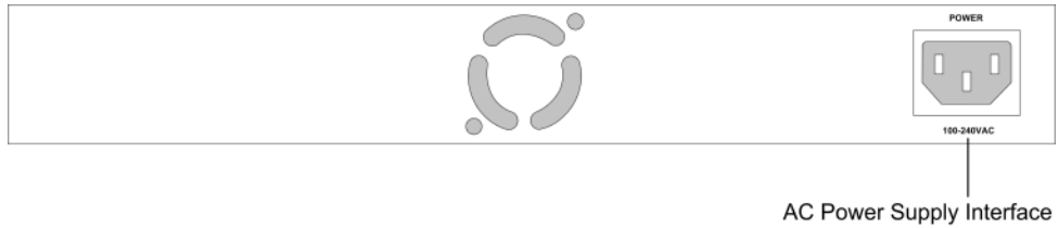
Рисунок 2-6. Задняя панель устройства PowerConnect 2724
